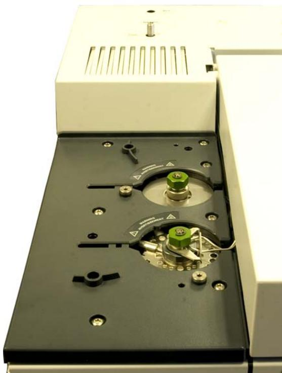
Las muestras se pueden inyectar en los inyectores a mano con una jeringa o con un dispositivo de muestreo automático (tales como el muestreador automático de líquidos de Agilent o el muestreador de espacio de cabeza de Agilent).
