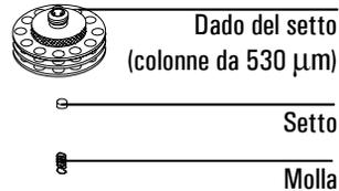
4. Inserire il filo metallico (o un piccolo tratto di colonna capillare) all'interno dell'iniettore e attraverso il forno quindi spingere fuori l'inserto e la molla (se non sono usciti prima) dalla parte superiore dell'iniettore.
