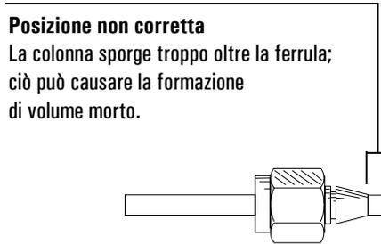
Utilizzare le istruzioni che seguono per installare dadi e ferrule SWAGELOK su colonne di metallo da 1/8" o da 1/4". Se sulla colonna sono già montate delle ferrule, passare alle istruzioni sul montaggio degli adattatori (pagina [154](#)) o delle colonne impaccate di metallo (pagina [155](#)).
