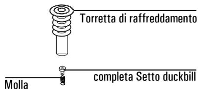
Inserire il setto duckbill nella molla e collocarlo nell' iniettore. Ricollegare il dispositivo della torretta di raffreddamento. Stringerlo bene.
