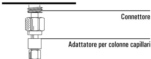
3. Installare un dado per colonne (codice 18740-20870) ed una ferrula in grafite (d.i. 1,0 mm, codice 5080-8773 oppure d.i. 0,5, codice 5080-8853) sulla colonna.
