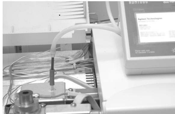
7 Conecte el flujómetro a su adaptador para medir los flujos.
