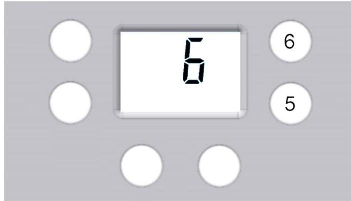
El punto de ajuste es regulable de 1 (más bajo) a 9 (más alto). Nominalmente, la temperatura del caudal de calefacción central (en la caldera) será de 50 ° C en la configuración más baja y 82 ° C en la configuración más alta.
