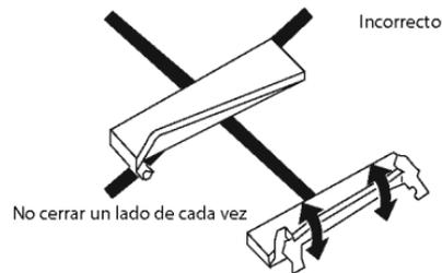
Encajar el plástico cosido en la lateral de la lona en el perfil, haciendo una palanca de tensión **I**, empezando el encaje por las extremidades **J** y finalizando por la región central **K**.
