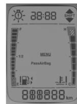
Esta función permite activar o desactivar el airbag del lado del pasajero a través de los botones ▲ y ▼
