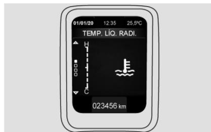
En régimen de funcionamiento normal, la indicación debe estar sobre los valores centrales de la escala **A**.
