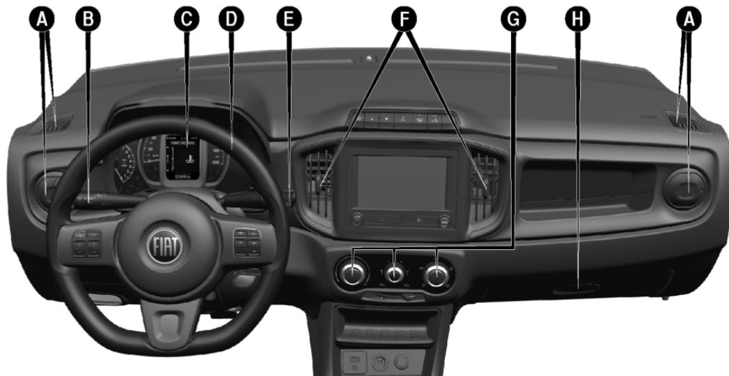
A. Difusores de aire laterales – B. Palanca izquierda (mando de las luces altas/bajas y de las luces de giro) – C. Cuadro de instrumentos – D. Volante – E. Palanca derecha (mando de lavado/limpieza del parabrisas) – F. Difusores de aire centrales – G. Mandos de calefacción, ventilación y aire acondicionado – H. Guantera
