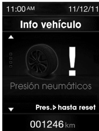
El sistema iTPMS indica al conductor la eventual presencia de una condición de presión de llenado diferente de la condición en el momento de la puesta a cero. Si esta condición bajar del límite de advertencia por cualquier motivo, incluyendo los efectos de la baja temperatura y la normal pérdida de presión de los neumáticos.
