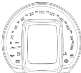
El kilometraje total y parcial se pueden visualizar en la pantalla. El kilometraje parcial se visualiza a través de la función **TRIP**, situada en la extremidad de la palanca derecha o, según el vehículo, a través del menú del ordenador de a bordo.
