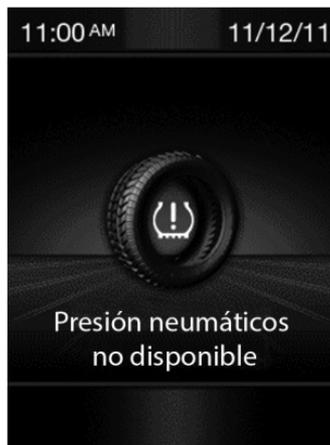
Si el sistema detecta que uno o más neumáticos están con presión inferior a la condición inicial de monitoreo del sistema (realizada tras la calibración y puesta a cero), deberá indicar a través de un pop-up en la pantalla seguido por el encendido del testigo
