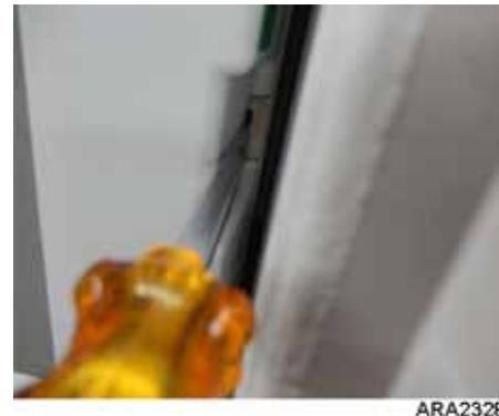
2. Mueva la empuñadura del destornillador hacia la izquierda para soltar el pestillo de la puerta del cerrojo de la caja.
