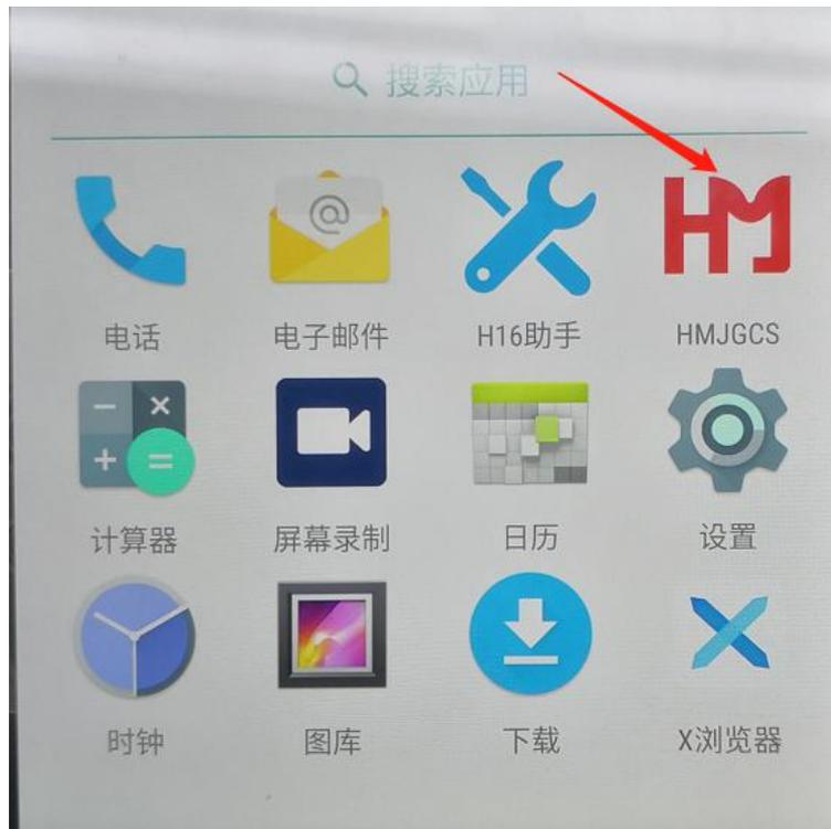
②打下后如下图，右上角显示空白，表示无人机未连接；如无人机上电后，会显示当前状态无人机的：星数/精度、及电池电压等信息；
