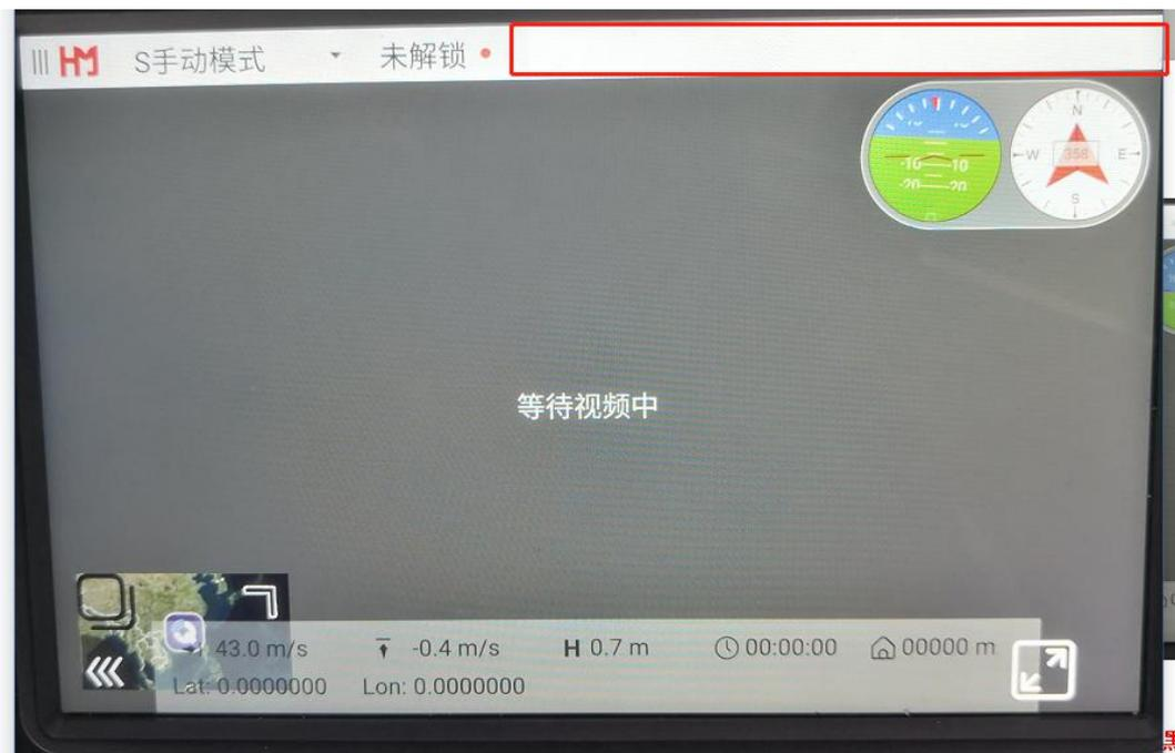
③无人机端接入电池通电（注意电池与无人机电源接法**“红对红”“黑对黑”**），此时遥控器端会语音提示已连接或显示无人机图像、电池电量、遥控器信号、无人机 GPS 信号等：
