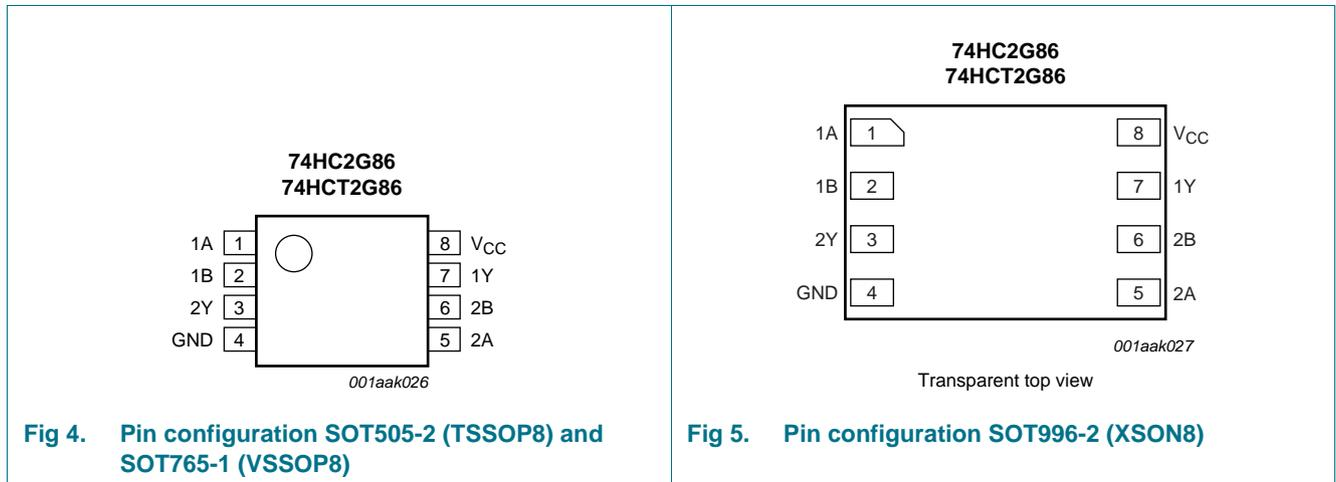
Fig 4. Pin configuration SOT505-2 (TSSOP8) and SOT765-1 (VSSOP8)
