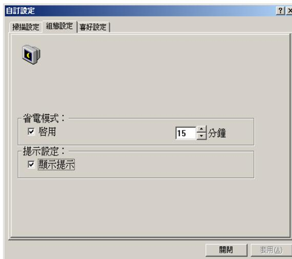
**Energy Saving Mode（省電模式）**— 核取 [Enable]（啟用）方塊可啓用自動關閉掃描燈管功能。您可以在「Minutes」（分鐘）方塊中指定 1 到 60 分鐘的延遲時間。在這段期間內，掃描器會等到上一個掃描操作完成後，才關閉掃描燈管。按一下 [Apply]（套用）按鈕以儲存變更。
