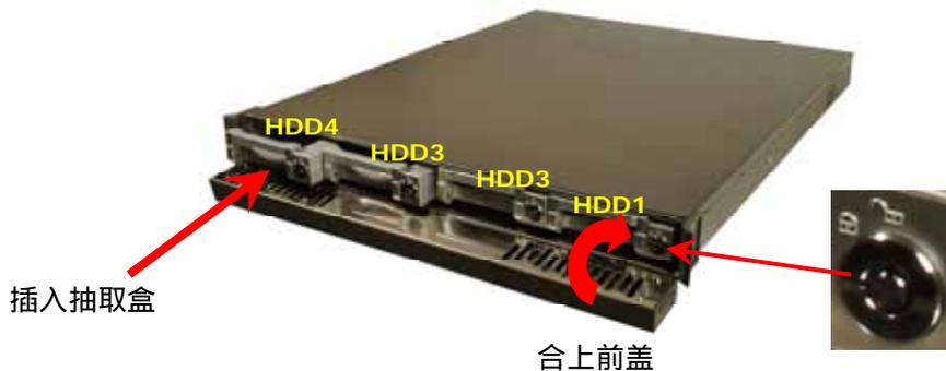
6. 完成后，请合上 TS-411U 前盖。注意所有硬盘必须由右至左以 HDD1 至 HDD4 顺序安装。
