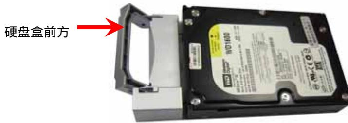
4. 反转抽取盒，确定硬盘的锁孔对准抽取盒底部的锁孔，再使用四颗平头螺丝锁紧硬盘。
