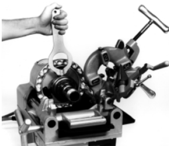
图 16 — 松开已套丝短管
