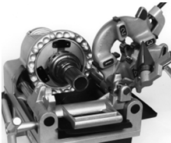
图 15 — 装入套丝短管
