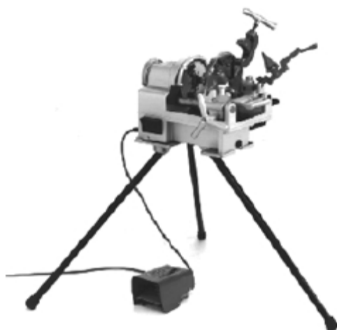
图3 — 套丝机固定到支架上
