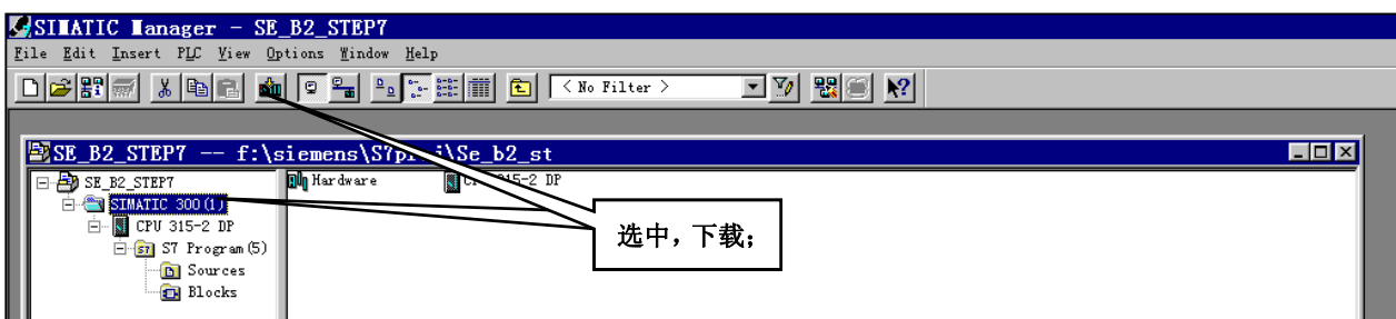
图 5-28 下载配置和程序
