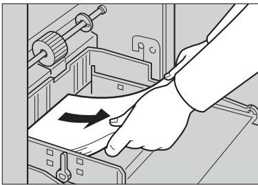
**2** 释放进纸侧导向板锁定杆。调整进纸侧导向板使之与新的纸张尺寸匹配。
