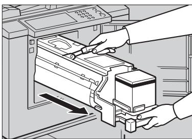
5 握住印筒上部的把手，将印简单元从机器上卸下。
