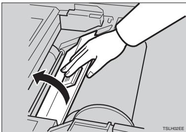
**3** 如果在**2**和**3**中无法取出卡住的版纸，可以拉出印筒，然后再从里面取出卡住的版纸。
