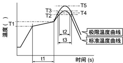
共晶焊接温度曲线 (63Sn/37Pb)
