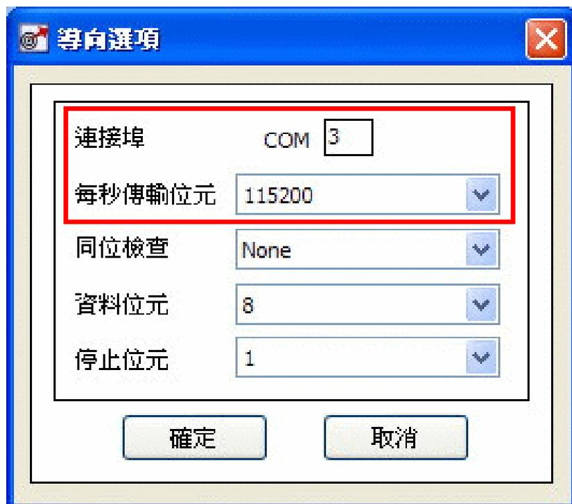
設定完成後在車機點擊滑鼠右鍵選擇“**導向串列埠**”，車機字體顏色變為藍色即表示定位資料已導向所指定的 COM Port。
