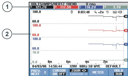
趋势图 (Trend) 屏幕在计量屏幕的一行内显示测量值随时间的变化。例如 VOLTS/AMPS/HERTZ TREND。时间为水平显示。趋势图显示在屏幕的右侧逐步形成。为了持续记录数据，在需要时，可压缩时间轴。
