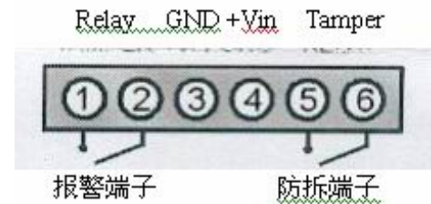
图示 2：探测器接线说明
