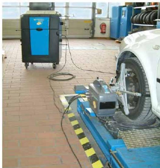
稍短些的两根通讯电缆（4.5 米）用来连接前后传感器
