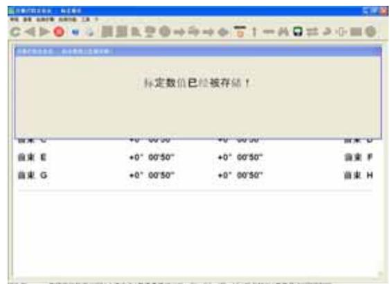
接下来可进行传感器外倾角的标定,标定过程与前束标定基本相同,按照标定程序引导操作即可。然后保存前束和外倾角标定的标定结果。
