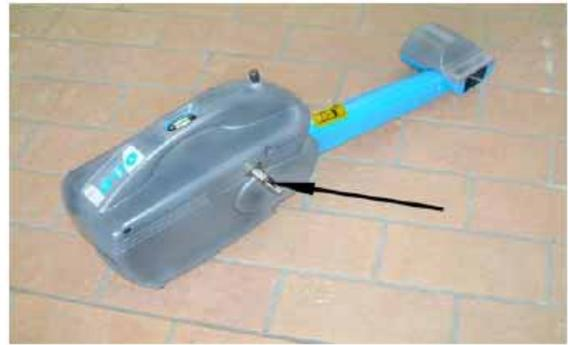
把四个传感器安装到卡具上。前轴车轮上的传感器小端指向车头前进方向，后轴车轮上的传感器小端指向与前轴传感器相反的方向。
