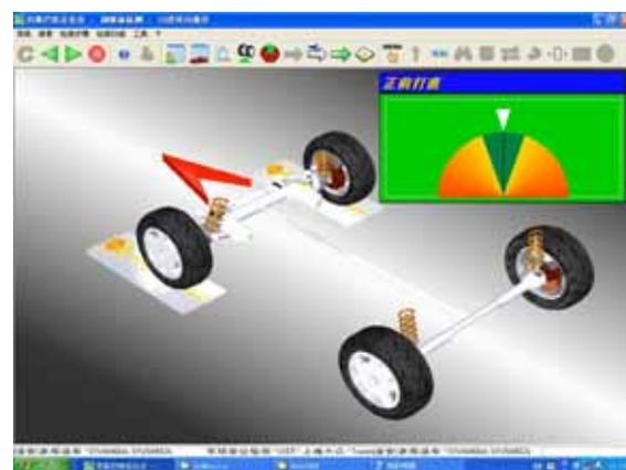
一旦正前打直方向之后，屏幕提示会提醒操作员安装刹车锁，然后程序就会检查传感器是否处于水平状态。如果有传感器不水平，则屏幕上就会出现水平气泡状态的提示画面，提示操作员对不水平的传感器进行水平调整。当所有传感器都处于水平状态之后，程序就会自动进入后轴数据测量步骤。
