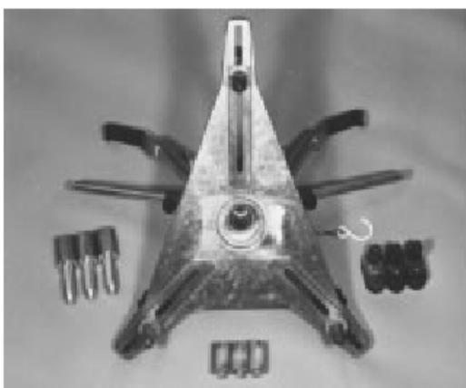
为了更好的在无沿铝合金钢圈上安装，可在卡爪上插上专用的卡爪套管。
