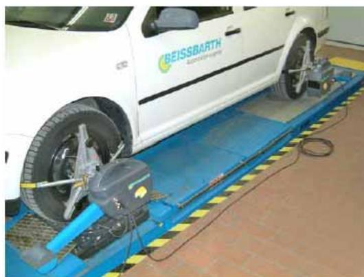
检查 4 个传感器连线是否连接牢靠，然后连接 220V 电源到定位仪。
