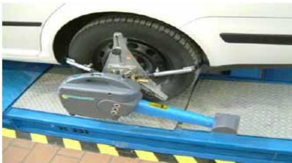
依照水平气泡指示调整传感器水平，并拧紧卡具上的固定螺钉（如图中箭头所示）。
