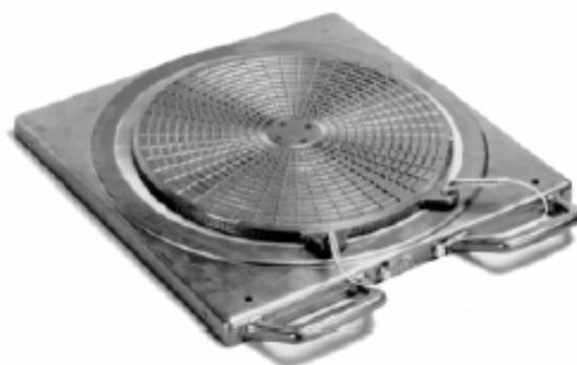
**长后滑板：**长×宽×高为 1050×460×50，最大承载为 1000 公斤，转动范围±2.5 度。这样在调整独立悬挂的后轮时，后轮可以自由转动。
