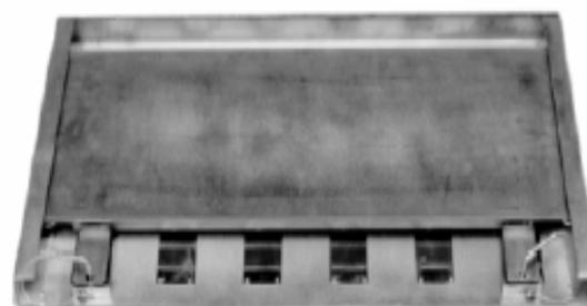
**遥控器：**使用遥控器上的四个键就可以调出完整的检测步骤，并在计算机屏幕上显示出测量步骤。遥控器使用红外线传输遥控信息。遥控器使用两节 1.5V 常规 7 号电池。
