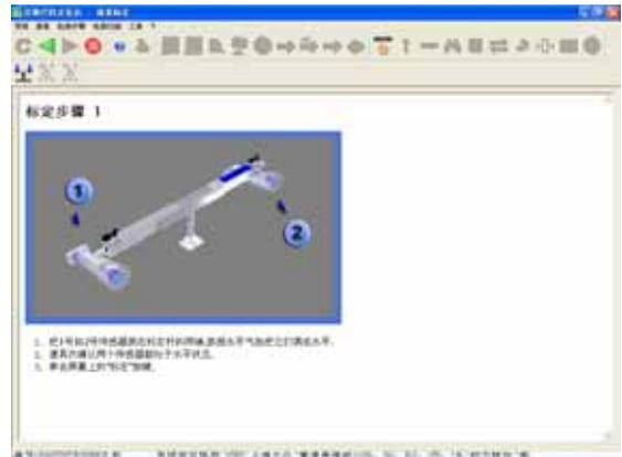
在标定过程中，请按照屏幕上的提示要求，转动标定杆。
