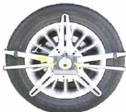
**电子转角盘：**可自由转动的转角盘能够消除车轮在转动时所产生的压力，并能完成车轮最大总转角的检测。
