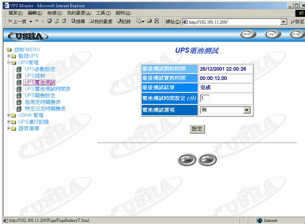
圖表3-10 UPS 管理頁面: UPS之電池測試
