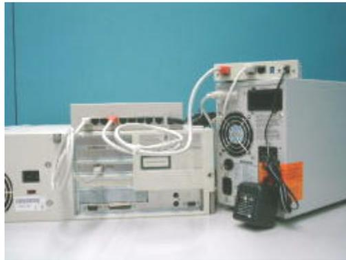
圖表2-17 從USHA/Mate的「區域網路」埠連接乙太網路電纜
