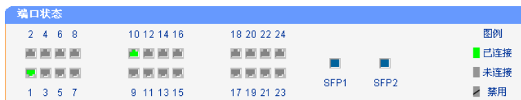
图 4-1 端口面板状态（无 SFP 模块）
