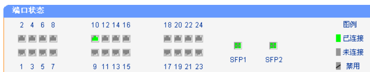
图 4-3 端口面板状态（插有 SFP 模块并已连接）
