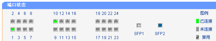
图 4-2 端口面板状态（插有 SFP 模块但未连接）
