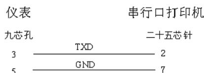
★注: 在连接打印机前请将仪表设定参数中通讯地址设为 Adr=01; 波特率设为 b = 2400。
