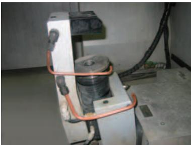
旋转型修正装置 (标准配置)+
