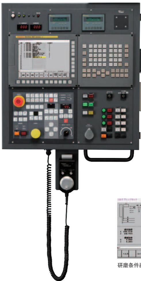
NC装置配备了素有好评的FANUC最新版本32i。太阳工机最大限度地有效利用此功能，研制出了对话式数据输入方式。与以往的输入方式相比，不要求程序员或操作员有很高的NC技术，是一种方便客户的输入方式。由此，可让更大层次范围的客户简单地进行高精度的研磨加工。此外，考虑到老客户的需求，也可以以以前的输入方式输入数据。
