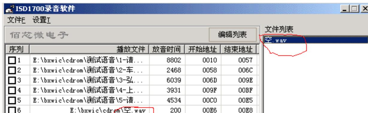
11、 添加文件完成后,调整电脑声卡音量在 1/3 位置,按 **播放**,开始对芯片录音,喇叭在录音的同时能监听到录音音频,如果音量较大,则减小声卡音量,再从头开始播放,如音量较小,则增大声卡音量。音量合适后,正式开始录音制作母片;一直到播放完毕。
