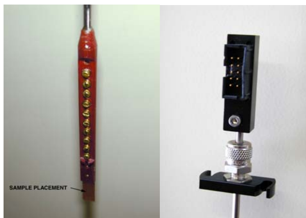
图 14 手动插入样品杆底部和顶部示意图
