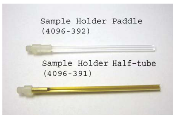
图 30 SQUID-VSM 样品固定杆（针对不同类型样品）
