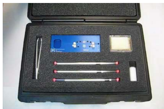
图 31 高温炉样品安装组件
