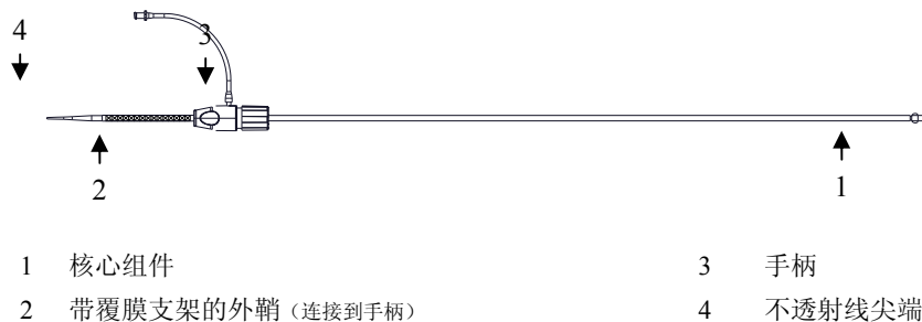
图 6. 用于 Powerlink 延长覆膜支架（21Fr）的 IntuiTrak 快速覆膜支架输送系统
