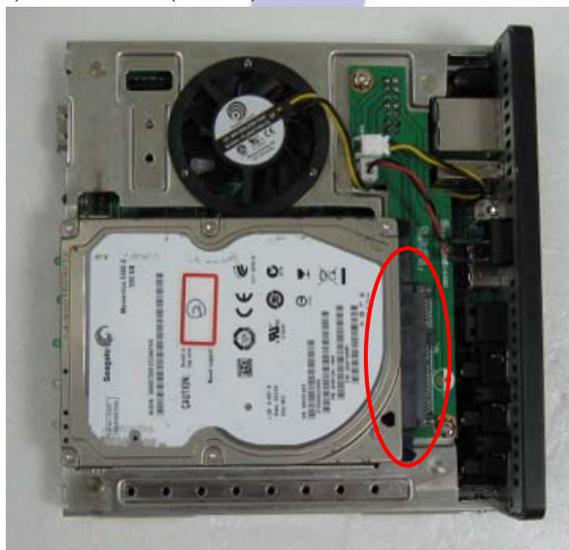
步骤 3: 硬盘安装后将两旁锁上螺丝固定硬盘。
