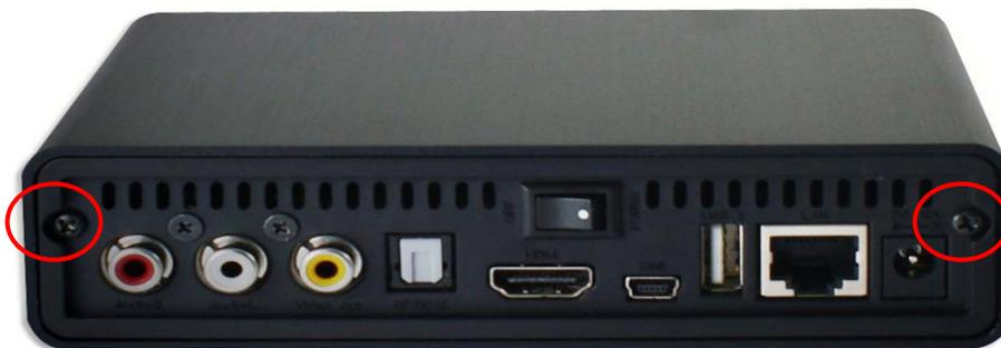
步骤 2：安装 2.5 吋 SATA 固态硬盘(SSD)或是硬盘(HDD)于产品 SATA 接口连结器上。
