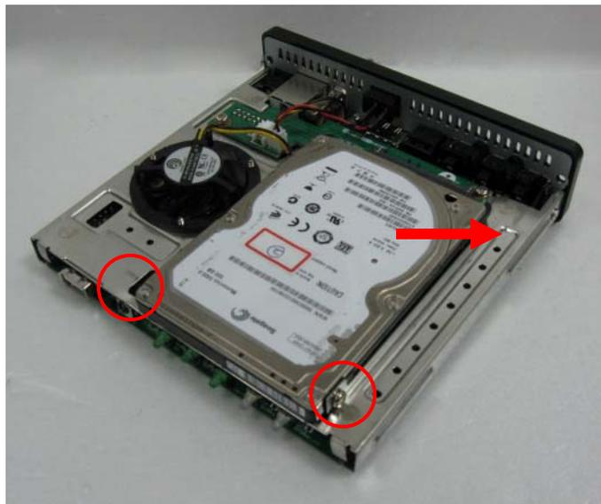
步骤 4: 将托盘安装进入 Box Office 机身，锁上螺丝完成安装。
