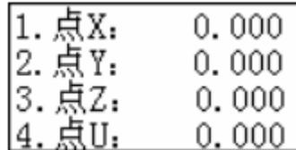
按移轴键，移动烙铁到“圆弧坐标 1”位置停止，按“确定”完成圆弧坐标 1（起点）
