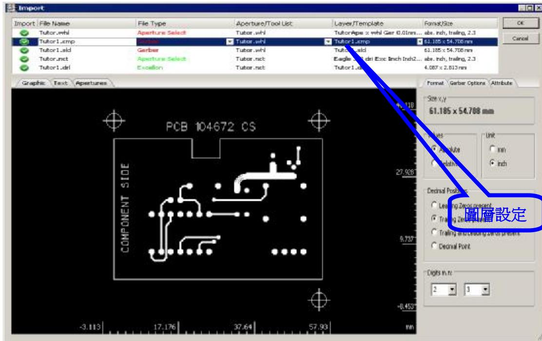
4.1.4.1 檢視預覽圖形中的[上層]、[下層]、[外框]及[鑽孔]是否正確，必要時適當的調整檔案中，Apertures/Tool 的設定，一般說來，只有[鑽孔]檔可能需要調整 Apertures 參數的部份設定，如[小數點位數]、[絕對/相對值]、[公制/英制]等設定。
