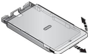
2 向后滑动纸盘盖直至卡入到位，大约 3 厘米（1.25 英寸），然后提起纸盘盖的一端。
