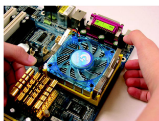
図 3. クリップがリテンション・メカニズムのフックに固定されるまでクリップレバーを同時に押し込んでください。
