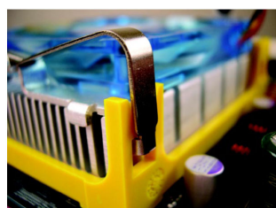
図 1. CPU クーラを CPU に設置してください。クリップラッチをリテンション・メカニズムのフックに合わせ、クリップを CPU クーラに設置してください。
