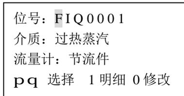
将光标移到【介质】选项, 按【0】键选择{过热蒸汽}; 按【q】键可将光标移到【流量计】选项, 按【0】键选择{节流件}。
