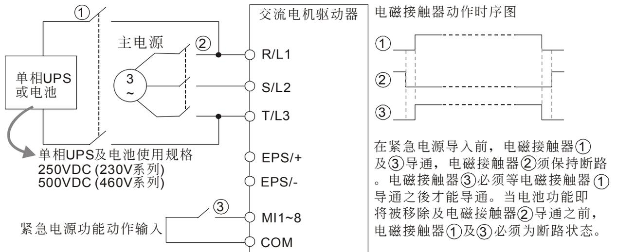
应用于两个电池主电池电压低于280Vdc
