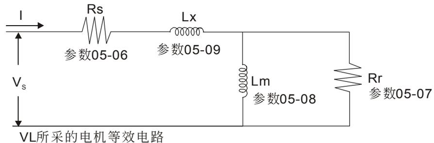
※ 当设定范围为 2 的静态量测，必须输入电机无载电流 05-05。
