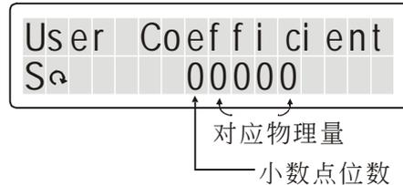
范例: 若使用者想用转速 (rpm) 的方式来设定电机的转速时, 若电机为 4 极 60Hz 则所对应的物理量为 1800, 所以此参数可设定为 01800, 表示 60Hz 对应 1800rpm 无小数点。若要显示 rps 则可设定为 10300, 表示 60Hz 对应 30.0 小数点 1 位。
