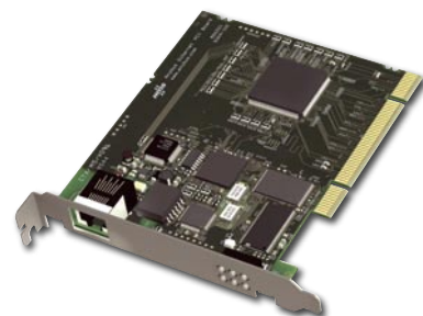
新的工业以太网接口卡内置Anybus软件和硬件
