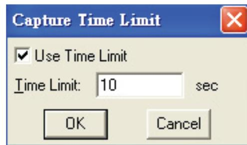
在AMCAP視窗，點選工具後先設定速度與時間限定。設定速度(Choose Frame Rate)可設定影片之每秒張數，預設為14張。設定時間限定(Capture Time Limit)為錄影時間，預設為10秒。待設定完成後，按下”開始錄影”即開始錄影。
