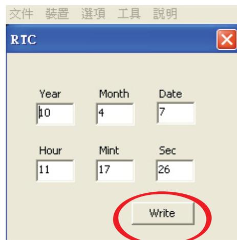
先將USB線連接SDVR及電腦，接著打開SDVR電源後再開啟AmCap\_RTC程式。可以看到SDVR播放的畫面就是正常了。然後在該視窗按下”說明” >> “RTC Setting”，按下後，點擊Write按鈕即可將時間和日期跟電腦的時間做同步。
