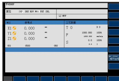
图 4-2-2-2 机床回参考点后 CRT 界面图
