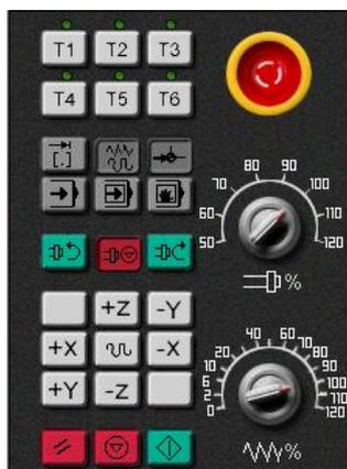
SIEMENS 802D 车床、铣床及加工中心操作面板
