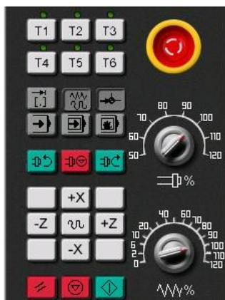
SIEMENS802D 车床操作面板
