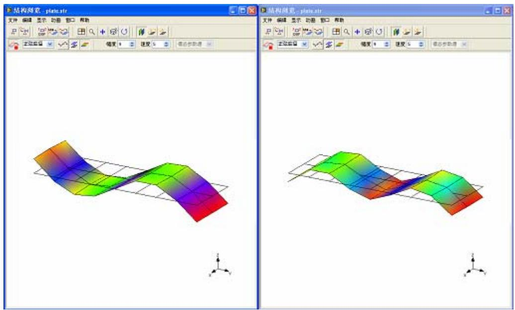
图 5-14 振型动画截图(左: 340Hz; 右: 660Hz)
