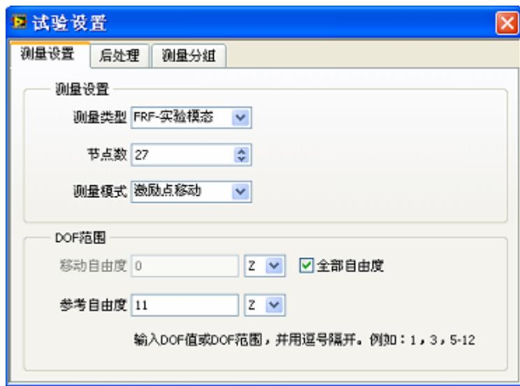
图 5-7 试验设置窗口的测量设置页
