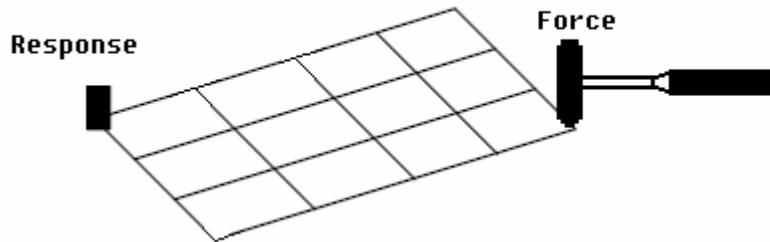
在本实验中，使用力锤作为激励，一个加速度计测量平板的响应。力锤信号和加速度计信号通过美国国家仪器（National Instruments）的动态信号采集（**DSA**）设备同步采集激励和响应信号。选定平板的 11 号节点作为参考点，加速度计固定于 11 号节点 Z 轴方向上，移动力锤按照顺序在平板的所有节点上敲击，获得所有点 Z 轴方向（移动自由度）与 11 号节点 Z 轴方向（参考自由度）之间的频率响应函数。
