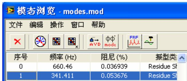
按下结构浏览窗口中的开始动画按钮 开始动画显示。设置结构浏览窗口中 **幅度** 9 和 **速度** 5，调整动画显示的幅度大小和帧率。按下显示结构表面按钮 和颜色渲染按钮 ，结构同时以变形和表面颜色改变来显示振型。按下显示未变型结构按钮 ，将重叠显示未变形结构和振型。图 5-14 显示频率为 341Hz 和 660Hz 时的振型动画截图。
