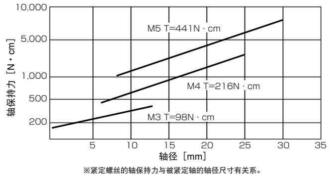
※紧定螺丝的轴保持力与被紧定轴的轴径尺寸有关系。
