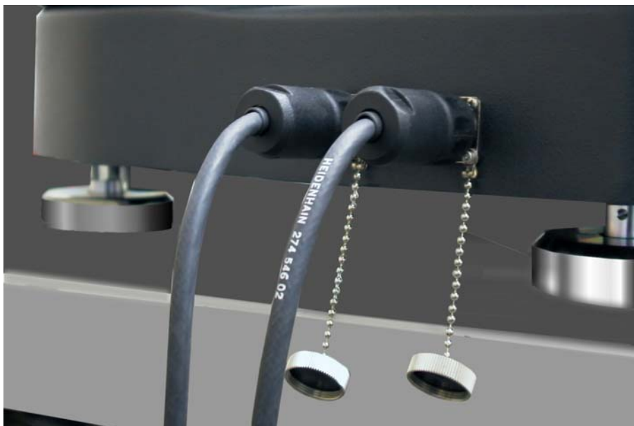
图 J1: Heidenhain 传感器至控制板 IK220 的电缆连接
