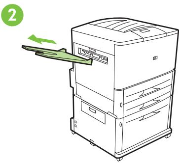
Wyjmij pojemnik wydrukiem w góre (jeśli go zainstalowano) i odłóż w bezpieczne miejsce. Po zainstalowaniu układača lub zszywacza/układača pojemnik ten nie będzie używany. **Uwaga:** W przypadku drukarki wielofunkcyjnej (MFP) należy upewnić się, że nie wyciągnięto z niej pojemnika skanera.
