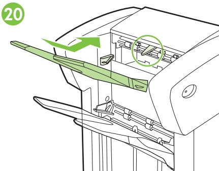
Przymocuj pojemnik dostarczony wraz z ukladaczem lub zszywaczem/ukladaczem do urządzenia wykańczającego wydrukiem w góre. Podczas wykonywania tej czynności należy zachować szczególną ostrożność, aby nie uszkodzić wskaźnika napełnienia pojemnika.
