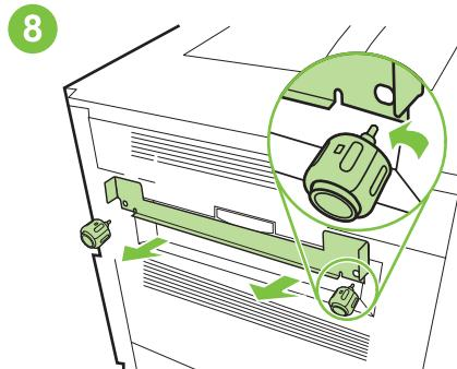
Skruta loss de två magneterna genom att vrinda dem motsols. Ta bort justeringsarmen av metall.
