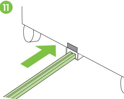
Placera ena änden av fästarmen i det U-formade-metallfästet på fack 4 och justera den efter armen med den grå etiketten.
