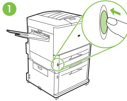
Jeśli drukarka jest podłączona do gniazdką sieciowego, naciśnij przycisk zasilania, aby ją wyłączyć (przycisk niewciśnięty).
