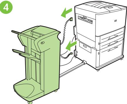
Odłącz przewody zasilające od urządzenia wykańczającego i podajnika 4 oraz przewód komunikacyjny od drukarki.
