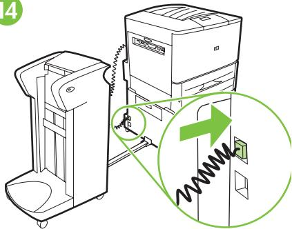
Podłącz przewód zasilający urządzenia wykańczającego do górnego gniazdku podajnika 4.
