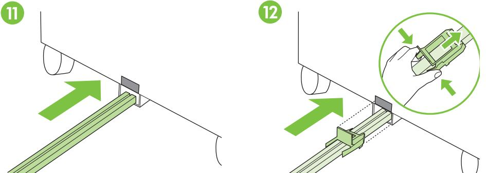
Umieść końcówkę pręta w metalowym otworze w kształcie litery U w podajniku 4 i ustal właściwe położenie pręta względem szarego oznaczenia.
