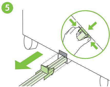
Lossa det blå plastfästet genom att trycka på fästflikarna och dra fästarmen ur ut metallfästet i fack 4.
