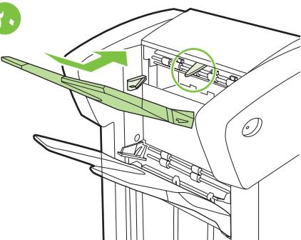
قم بتركيب الحاوية العلوية - التي تُرفق بوحدة التجميع أو وحدة التدبيس/التجميع - في جهاز الإنماء. عند تركيب الحاوية العلوية، انتبه حتى لا تتسبب في تلف علامة امتلاء الحاوية العلوية.
