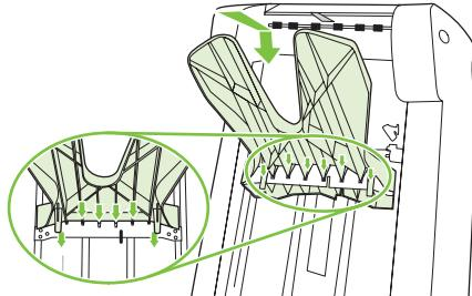
Zainstaluj tacę układacza, dopasowując otwory do metalowego pręta urządzenia i maksymalnie dociskając tacę. **Uwaga:** Tacy układacza nie należy instalować w plastikowych uchwytach urządzenia wykańczającego.
