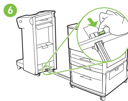
Przed przesunięciem urządzenia wykańczającego unieś niebieską klapkę na przecie łączącym w kierunku oznaczonym strzałką.
