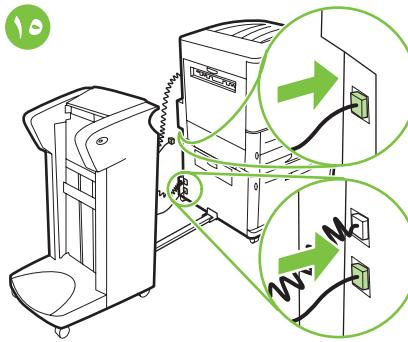
قم بتوسيط سلك التيار الخاص بالطابعة إلى الطابعة. قم بتوسيط سلك التيار الخاص بالدرج ٤ إلى الدرج ٤. ملاحظة: لا تقم بتوسيط أي سلك تيار إلى مقبس التيار المتردد الآن.
