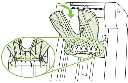
قم بتركيب حاوية وحدة التجميع، من خلال ضبط الفتحات مع دعامة المعاوذه المعدنية، ثم دفع حاوية وحدة التجميع حتى تستقر في مكانها. ملاحظة: لا تحاول توصيل حاوية وحدة التجميع بالأجنحة البلاستيكية الموجودة على جهاز الإنماء.
