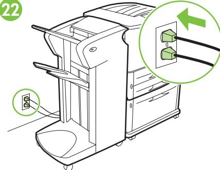
Podłącz przewód zasilający drukarki do gniazdka sieciowego. Następnie podłącz przewód zasilający podajnika 4 do gniazdka sieciowego. **UWAGA:** Urządzenie wykańczające należy podłączyć do gniazdku z zasilaniem o natężeniu minimum 15 amperów.
