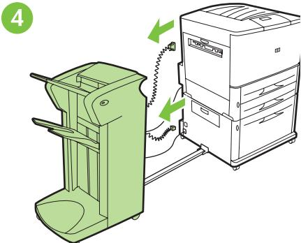
Koppla bort nätsladdarna från efterbehandlingsenheten och fack 4. Koppla bort kommunikationskabeln från skrivaren.
