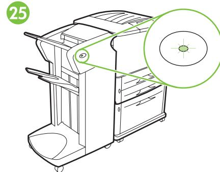
Kontrollera att lampan på efterbehandlingsenhets framsida lyser grönt med fast sken. Om lampan lyser med gult sken, blinkar eller är släckt ser du efter i onlineguiden *Use* på adressen [www.hp.com](http://www.hp.com).
