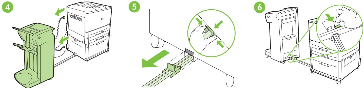
Αποσυνδέστε τα καλώδια τροφοδοσίας από τη συσκευή τελικής επεξεργασίας και το δίσκο 4 και αποσυνδέστε το καλώδιο επικοινωνίας από τον εκτυπωτή.
