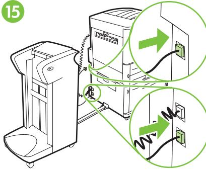
Następnie podłącz przewód zasilający drukarki. Podłącz odpowiedni przewód zasilający do podajnika 4. **Uwaga:** Żadnego z przewodów zasilających nie należy na tym etapie podłączać do gniazdką sieciowego.
