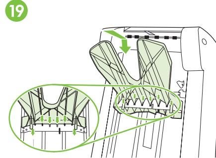
Fäst utmatningsfacket för stapling genom att passa in hålen med metalljusteringsfästet och trycka utmatningsfacket på plats.
