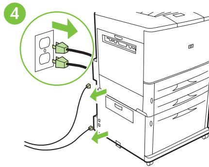
Wyjmij z gniazdek po obu stronach wtyczki przewodów zasilających drukarki i podajnika 4
