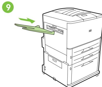
Sätt tillbaka utmatningsfacket för framsidan uppåt (levererat med skrivaren).
