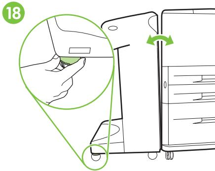
Om det finns ett ojämnt mellanrum mellan skrivaren och efterbehandlingsenheten justerar du det med de blå reglagen ovanför hjulen på efterbehandlingsenheten så att mellanrummet minskas. Ett smalt parallellt mellanrum är godtagbart. Följ anvisningarna på etiketten ovanför hjulen.
