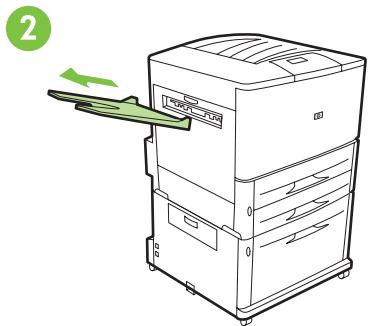
Ta bort utmatningsfacket för framsidan uppåt om det är installerat och spara det. Det används inte när arksamlaren eller arksamlaren med häftningsfunktion är ansluten till skrivaren.
