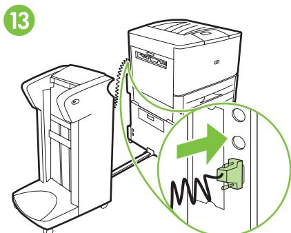
Podłącz przewód komunikacyjny do złącza drukarki oznaczonego jako „Accessory” („Wyposażenie”).
