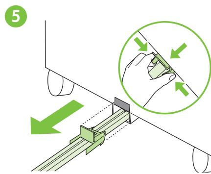
Aby zwolnić niebieski plastikowy wspornik, ścisnij klapki zwalniające i wysuń pręt łączący z metalowego gniazda w podajniku 4.
