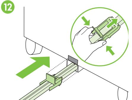
Wsuń niebieski plastikowy wspornik do metalowego gniazda tak, by zablokować go we właściwym położeniu. **Uwaga:** Płytką wspornika zakryje szare oznaczenie na podajniku 4.
