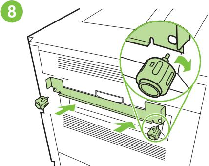
Umieść metalowy wspornik wyrównujący i magnesy na wysokości otworów po zaślepkach i przymocuj wspornik, wkładając magnesy w otwory.
