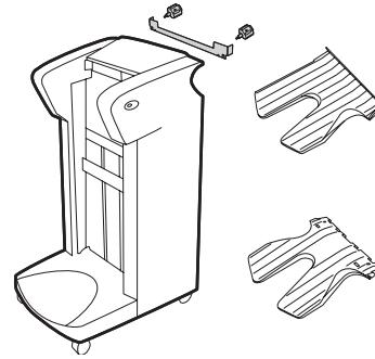
وحدة التجميع سعة ٣٠٠٠ ورقة أو وحدة التدبيس/التجميع سعة ٣٠٠٠ ورقة، وحاوية التجميع، والحاوية العلوية، وحجري المغنتيس، ودعامة المحاداة المعدنية
