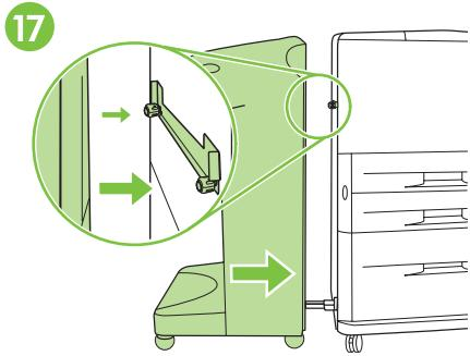
Tryck efterbehandlingsenheten mot skrivaren. Efterbehandlingsenheten ska glida in och få kontakt med de två magneterna på skrivaren och låsa efterbehandlingsenheten på plats.
