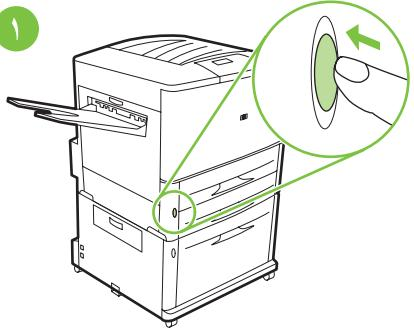
إذا كنت قد قمت بتوصيل الطابعة بمقياس تيار متعدد بالفعل، اضغط على زر الطاقة لفصل التيار (الزر إلى الخارج).
