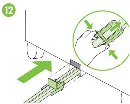
Skjut in det blå plastfästet i metallfästet tills det snäpper på plats. **Obs!** Fästet ska täcka den grå etiketten på fack 4.
