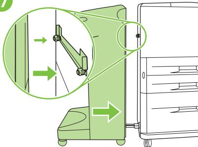
Dosuń urządzenie wykańczające do drukarki. Urządzenie wykańczające powinno stykać się z dwoma magnesami na drukarce, co umożliwia zablokowanie go w odpowiednim miejscu.
