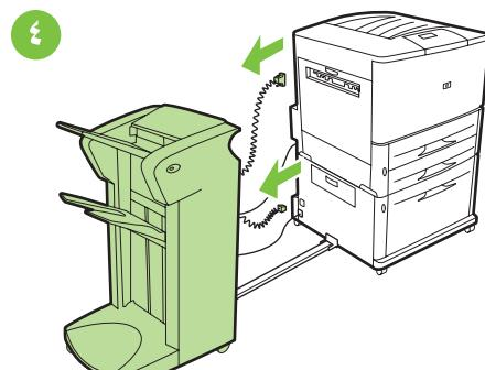
افصل سلك التيار الخاص بجهاز الإناء وسلك التيار الخاص بالدرج ٤، وافصل كابل التوصيل من الطابعة.
