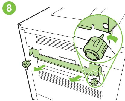
Odkręć dwa magnesy w kierunku przeciwnym do ruchu wskazówek zegara. Zdejmij metalowy wspornik wyrównujacy. **Uwaga:** Należy uważać, aby nie zgubić magnesów lub metalowego wspornika wyrównującego podczas wymiany lub przesuwania urządzenia wykańczającego. Magnesy i metalowy wspornik wyrównujący są niezbędne do instalacji urządzenia wykańczającego.
