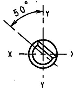
軸は反時計方向に回し切った状態を示す。
