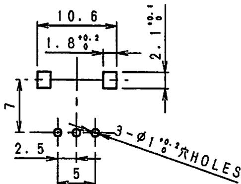
端子取付穴寸法図 (挿入側より見た図)
