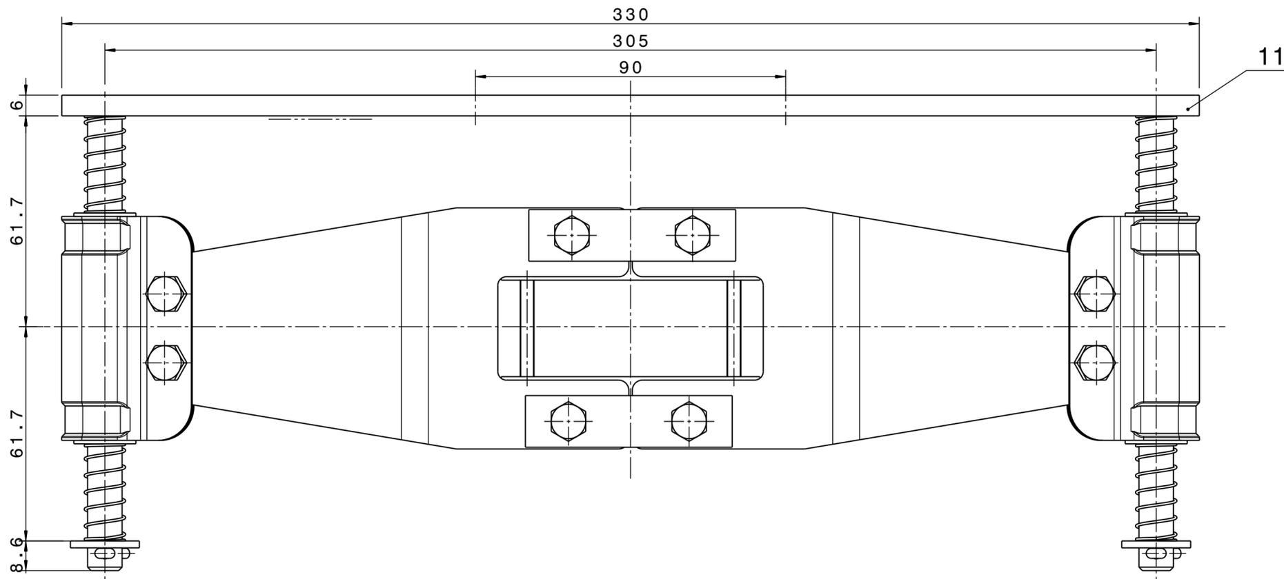
Schräger Kabelabgang durch Umsetzen der Befestigungsschellen kundenseitig möglich
