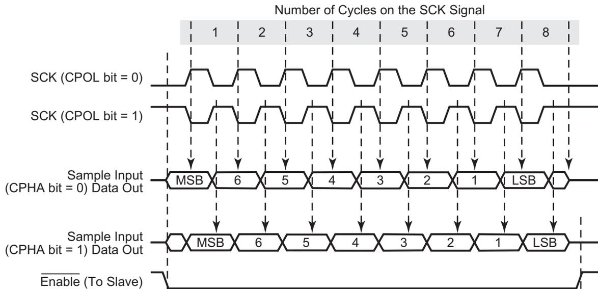
Figure 29. SPI Timing
