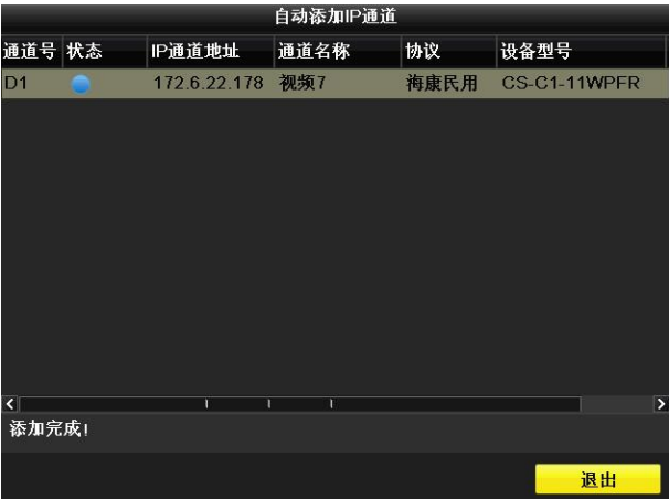
图5.11 完成快速添加 IP 通道界面
