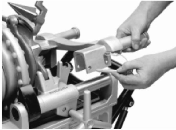
图5 — 适配器支架安装到300C套丝机上
