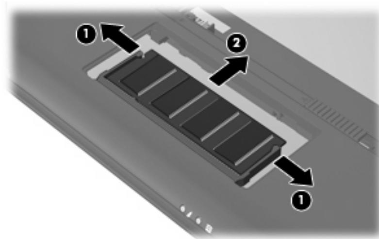
将取出的内存模块放入防静电的包装中，以保护内存模块。
