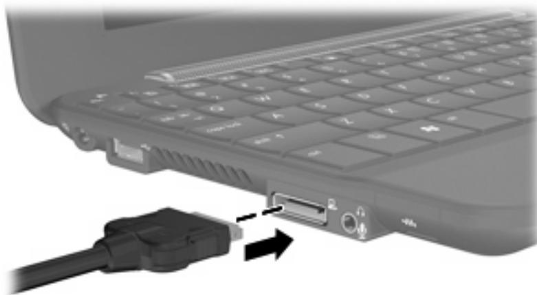
2. 将外接显示器或投影机连接到电缆的另一端。
