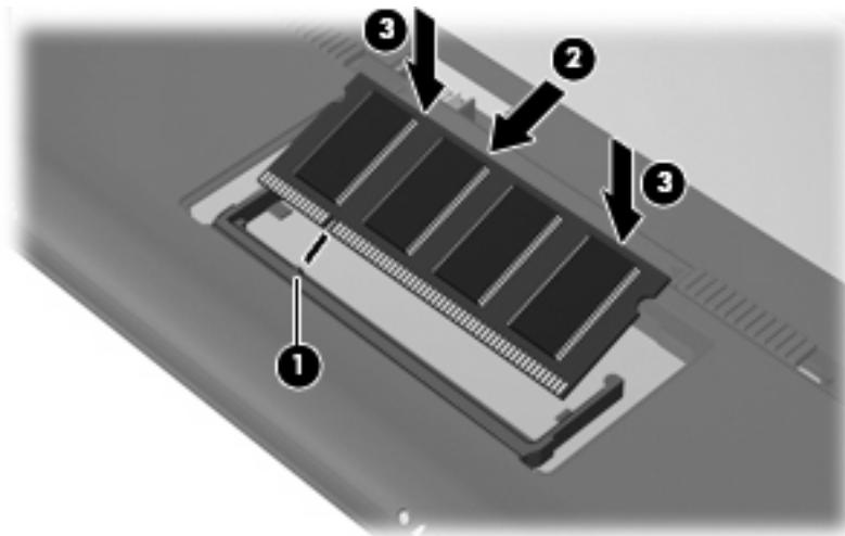
11. 将内存模块盒盖上的卡舌 (1) 对准设备上的卡槽盖。
