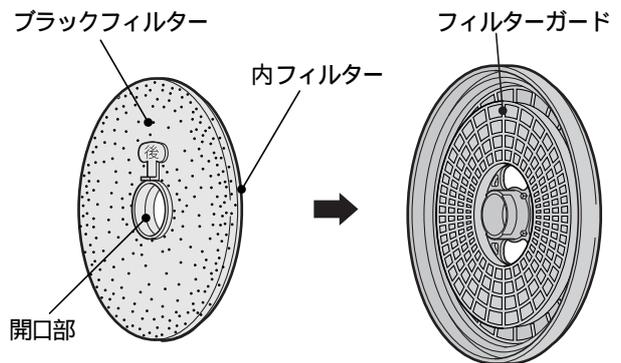
フィルターセットをバックフィルターに取り付けます。
