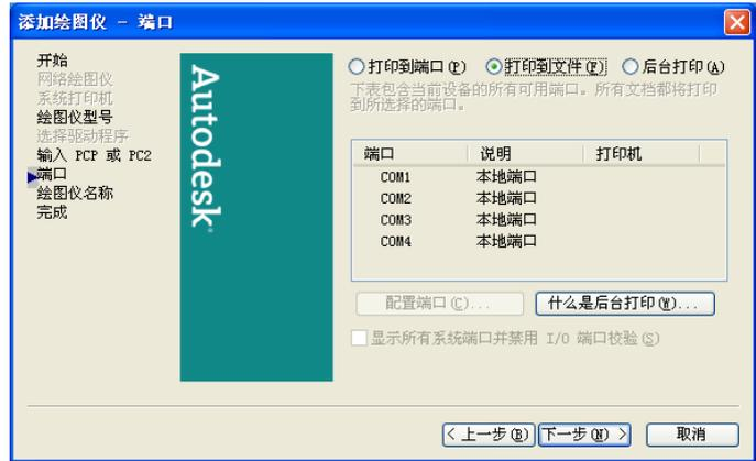
3. 单击“文件”下拉菜单中的“打印”菜单项，弹出打印对话框，单击“打印设备”选项卡，在“名称”下拉列表中选择生成 PLT 文件的打印机，在“文件名和路径”编辑框中填写输入路径，并勾选“选打印到文件”复选框。
