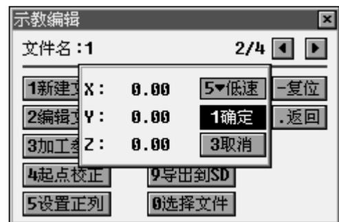
将胶枪针头移动到实际需要的加工起点, 确定即可, 界面随即返回到“示教编辑”界面。
