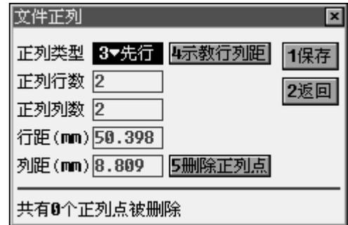
注意该功能是对文件进行正列，假设 A 文件是已经编好的标准整圆，要将其正列成一个 2 行 2 列的文件来满足工件的加工要求，行距是 50.398，列距是 8.809。行列距可通过示教方式拾取，拾取方法是移动到最后一行最后一列的正列单元的加工起点，系统自动计算行距和列距。
