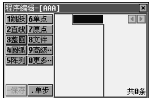
界面分为三列，左边罗列了控制命令以及编程指令，中间以及右面为用户指令编辑区。在编辑程序时，可直接按下快捷数字键 1~8，插入指令显示到中间的用户指令编辑区，同时最右边区域会显示出改指令的坐标或参数。
