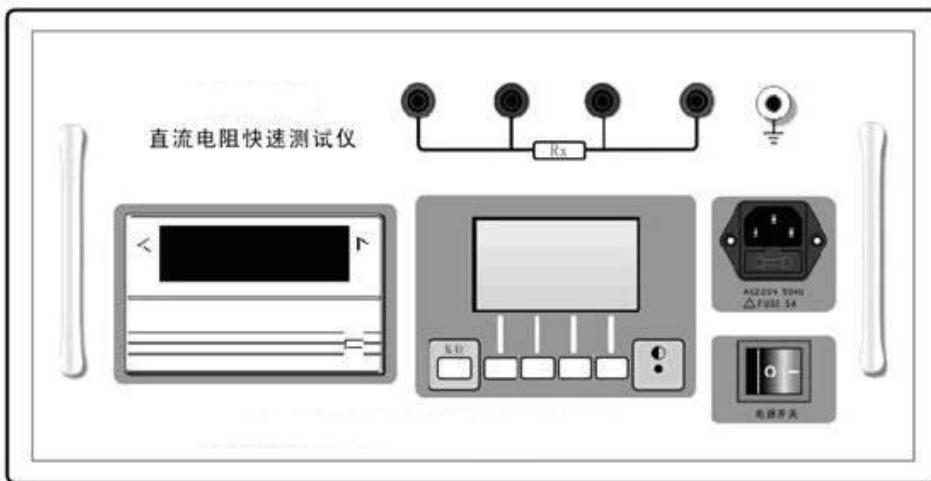
直阻仪的面板布局如上图所示，包括打印机、液晶显示器、键盘、电源插座和电源开关以及接线端子、接地端子。
