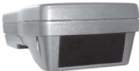
图 7 MDU 的红外发射/接收窗口
