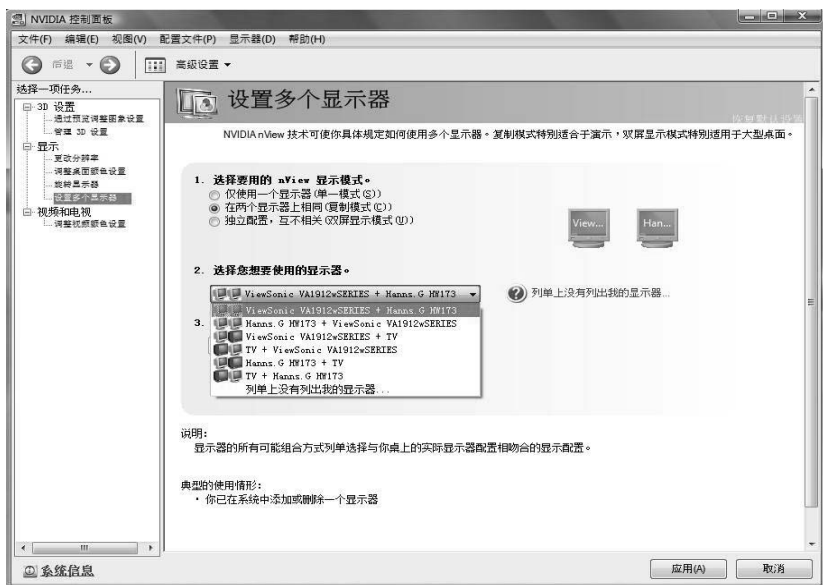
(图三) 连接 D-Sub + D-Sub 的配对模式
