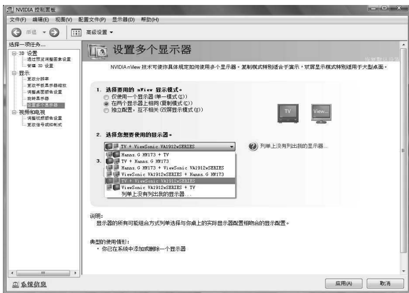
(图六) 连接 DVI-I + TV-Out 的配对模式
