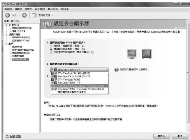
(圖五) 連接 DVI-I + D-Sub 的配對模式
