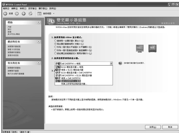
(图二) 连接 D-Sub + TV-Out 的配对模式
