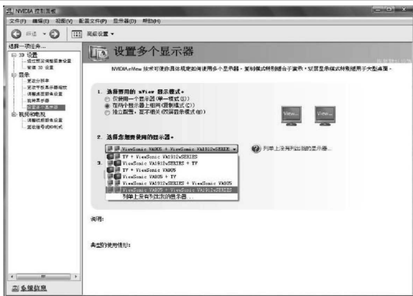
(图四) 连接 DVI+DVI + DVI-I 的配对模式
